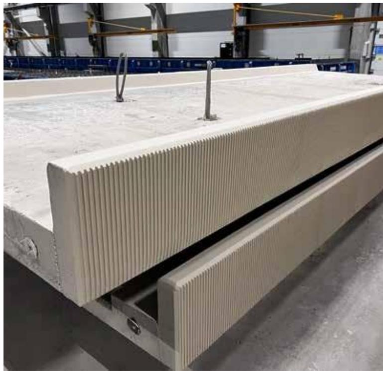
Los paneles prefabricados para balcones son una solución constructiva completa que proporciona un elemento de construcción listo para usar, fabricado en una avanzada planta de prefabricación. Uno de los principales puntos fuertes de este producto es su flexibilidad, que permite adaptarlo a las necesidades individuales del cliente. Cabe destacar que es posible equipar estos paneles con un conector térmico Izokorb incorporado, lo que aumenta aún más su valor y eficiencia energética.
